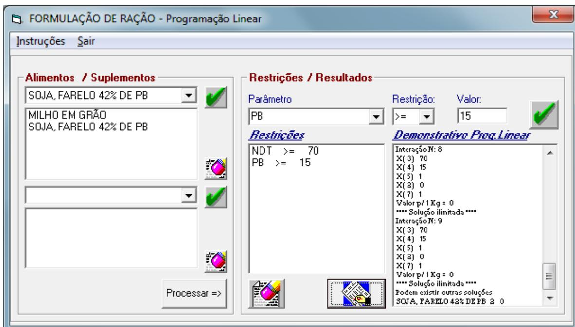
Figura 17. Método do Custo Mínimo: Demonstrativo da Programação Linear
